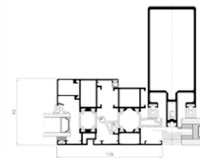
a homlokzatban nyíló ablak metszete
